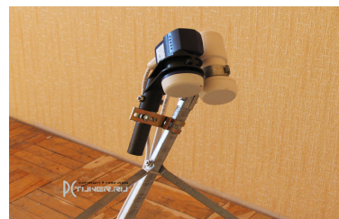
Рисунок 3 – Разновидности установки нескольких конвертеров для спутниковой антенны
